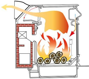
Le clapet est ouvert, le thermostat est réglé de façon à permettre l'arrivée d'une grande quantité d'air.
