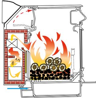
Recharger en bois, et régler l'arrivée d'air primaire de façon à obtenir la combustion désirée. Dès que la température atteint 260°C, fermer le clapet d'évacuation des fumées.
