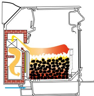
La combustion des gaz volatiles est quasi complète. Le dégagement de chaleur se poursuit de façon constante pendant plusieurs heures. Dès que le lit de braises diminue, ouvrir le clapet d'évacuation des fumées avant de recharger le bois.
