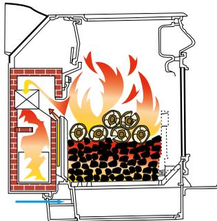
Les arrivées d'air primaire et secondaires sont réglées de façon à obtenir le dégagement de chaleur souhaitée. La combustion secondaire se poursuit dans le catalyseur.
